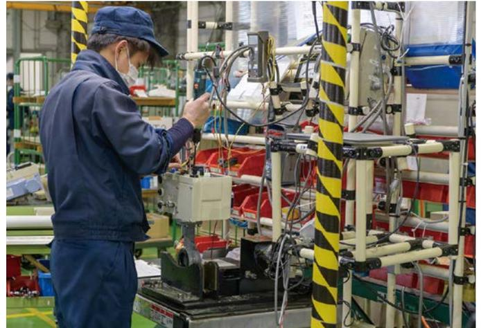
電子制御バタフライバルブの組み立て作業の様子
