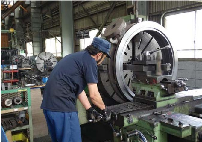
バタフライバルブ本体の旋盤加工作業の様子
